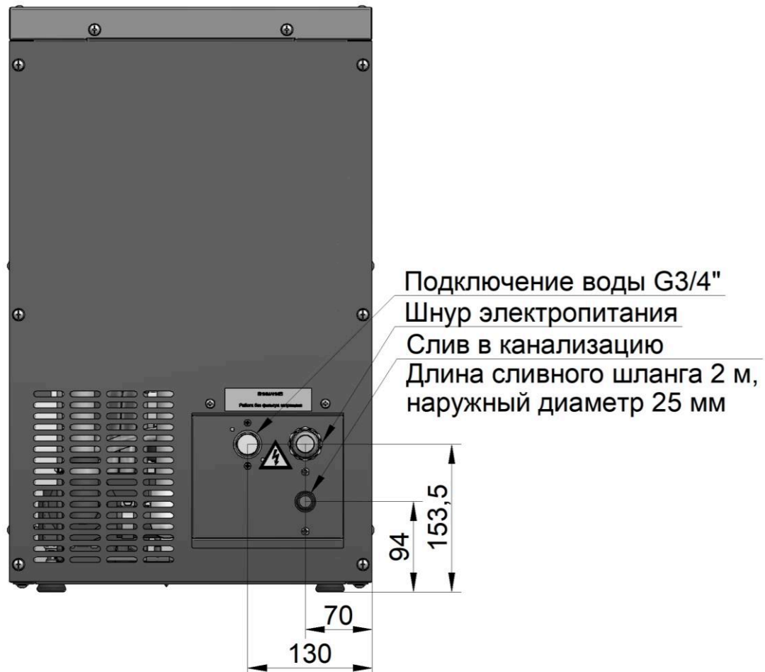
Рис. 5 Схема подключения льдогенератора
